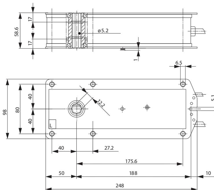
Электропривод для управления противопожарными нормально открытыми (огнезадерживающими) клапанами, установленными в системах кондиционирования, общеобменной, местной и технологической вентиляции. Совмещенный с термоэлектрическим выключающим устройством с кнопкой тестирования BAE72B-S
