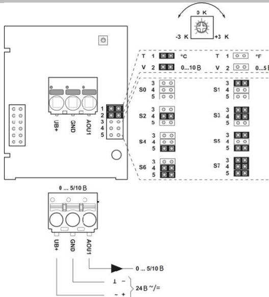
Регулировка диапазонов измерений производится путем изменения переключателей. Выходное значение в новом диапазоне измерений доступно через 2 секунды
