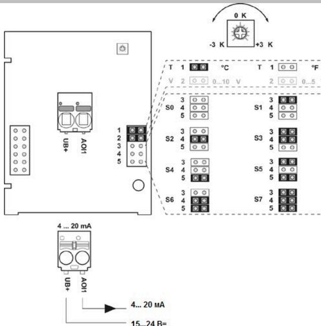
Регулировка диапазонов измерений производится путем изменения переключателей. Выходное значение в новом диапазоне измерений доступно через 2 секунды.
