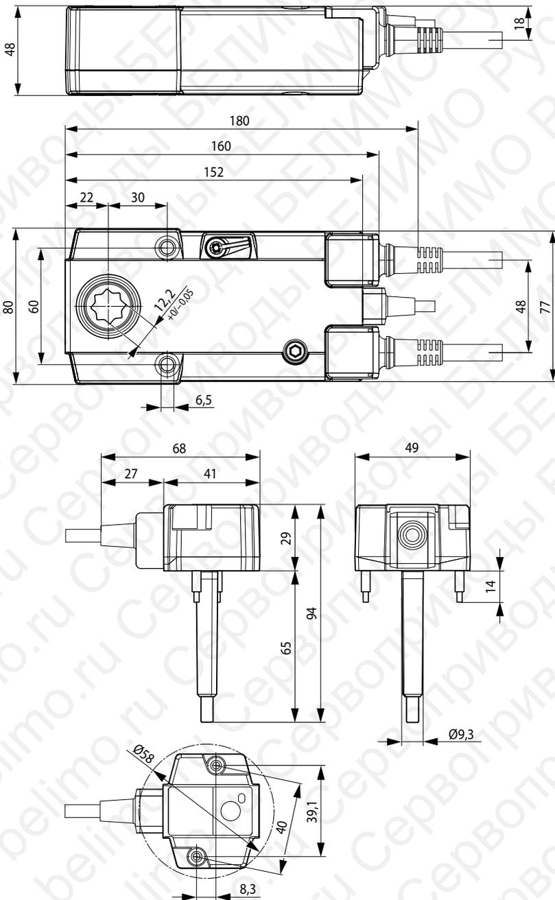
Электропривод для управления противопожарными нормально открытыми (огнезадерживающими) клапанами небольших размеров, установленными в системах кондиционирования, общеобменной, местной и технологической вентиляции
