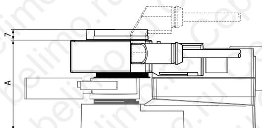
Вспомогательные переключатели для установки на приводы воздушных заслонок серий: NF..A., SF..A., LF..
